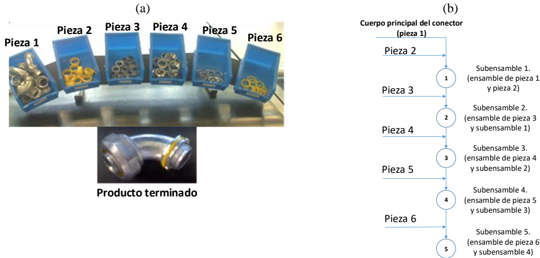
Figura 1: (a) componentes que conforman el conector y (b) Proceso de ensamble del conector
