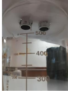
Figura 9. Sensor ultrasónico montado sobre recipiente graduado
