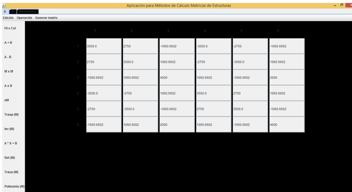
Figura 4: Ejemplo del ingreso de los datos para la matriz global de rigidez.
