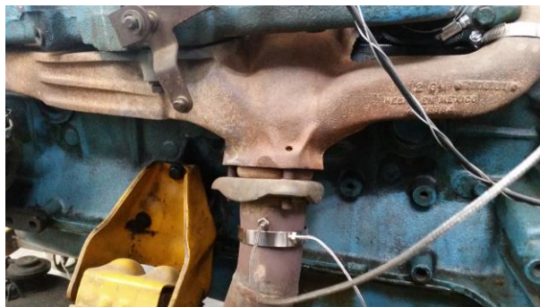
Figura 2. Sistema de escape adaptado con termopares.
