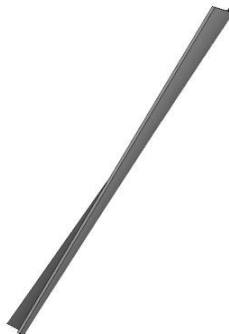
Figura 3. Alabe con curvatura sencilla y torsión (vista isométrica)
