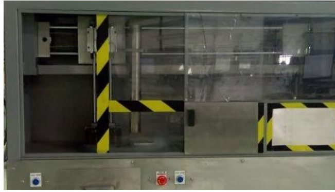
Figura 1.4 (Guarda de seguridad y paro de emergencia)
