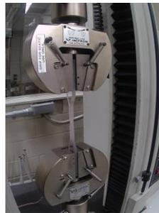
Figura 3. Máquina universal Instron
