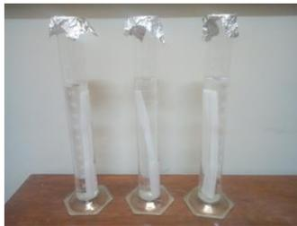
Figura 5. Inmersión de probetas en el reactivo.
