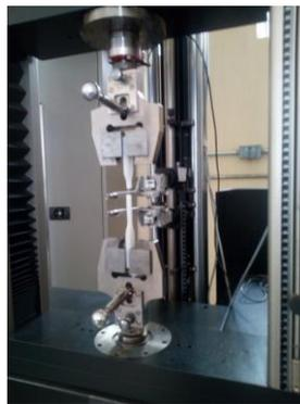
Figura 7. Ensayo de tensión.
