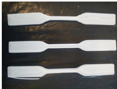
Figura 6. Probetas de PC después de 168 hr. en acetona.
