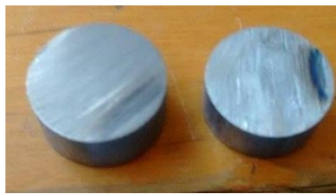
Imagen 1.1 Imagen de muestras antes y después del borurado.
