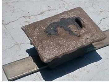
Imagen 3.2 Recipiente después del tratamiento termoquímico de cementación.
