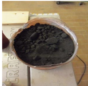
Imagen 5.1 Postproducción de residuos de proceso borocementado en caja.
