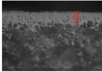
Imagen 2.2 Micrografía muestra 7 a 200x después del tratamiento borocementado en caja.
