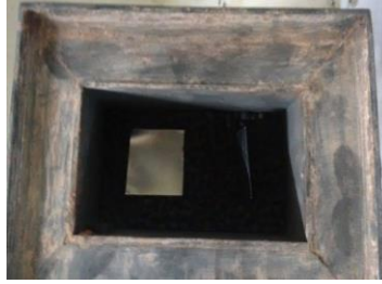
Imagen 3.1 Hoja de acero AISI 1010 de 1" x 1" en el recipiente de metal para la cementación.
