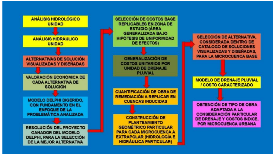
Figura 4 Modelo Simplificado de extrapolación de resultados de microcuencia individual.
