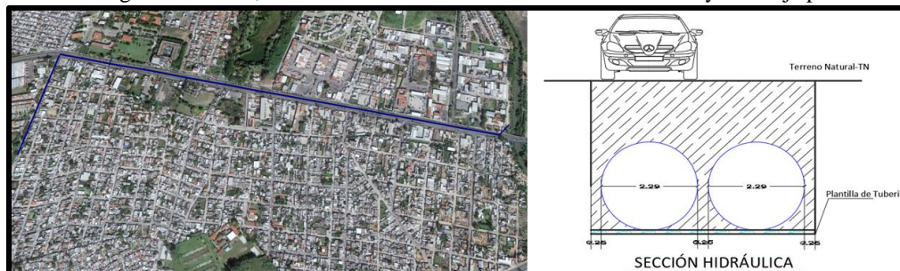
Figura 5 presentada por (Serrano, 2018), en su esquema “7. Línea doble de 2.29 m. con un recorrido desde el ITT sobre la Av. Tecnológico hasta desalojar el agua en el Río Mololoa”, la cual es la alternativa colegiada.
