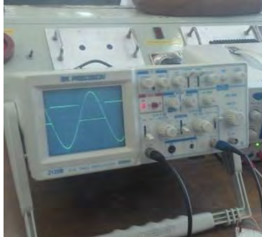
Figura 6. Grafica de salida del detector de cruce por cero
