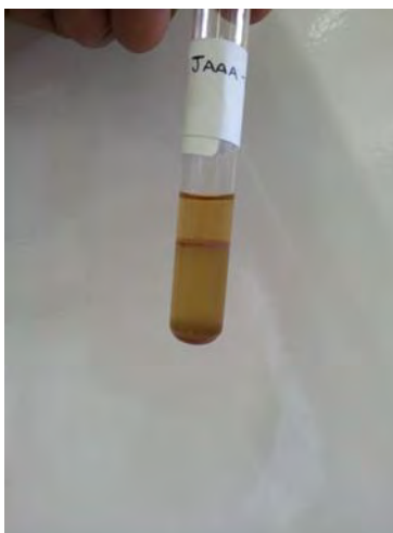
Figura 4. Formación de dos fases biodiesel y glicerina.
