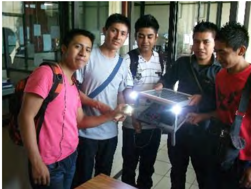
Figura 8. SSFV con panel de 10 W y lámparas de 1 W.
