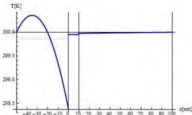
Figura 2. Curva de temperatura T en función de la posición para un nanopilar CMS/Au/Cu de longitud 50nm/10nm/90nm. La línea punteada representa la temperatura promedio T_{prom} = 299.9 K del CMS. Se obtienen curvas similares para nanopilares en donde se mantiene fija L_{Au} = 10 nm.
