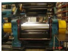
**PASO 5:** Colocación de master batch en rodillos del molino.
