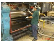
**PASO 6:** Colocación de químicos en el master batch que se encuentra en rodillos del molino.
