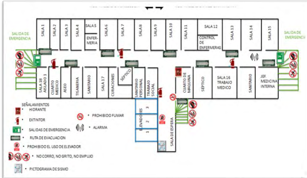
Figura 3. Instalación con señalizaciones.
