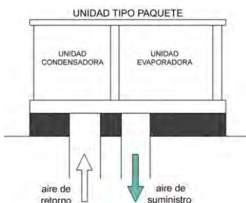
Figura 1.3 Detalles de descarga vertical.
