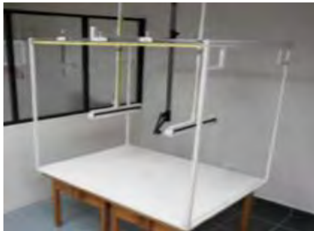
Figura 1. Cabina del sistema de visión artificial
