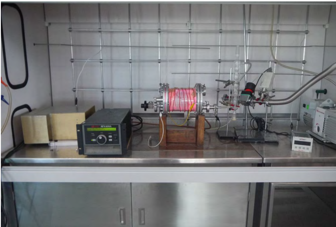
Figura 1. Reactor de plasma utilizado
