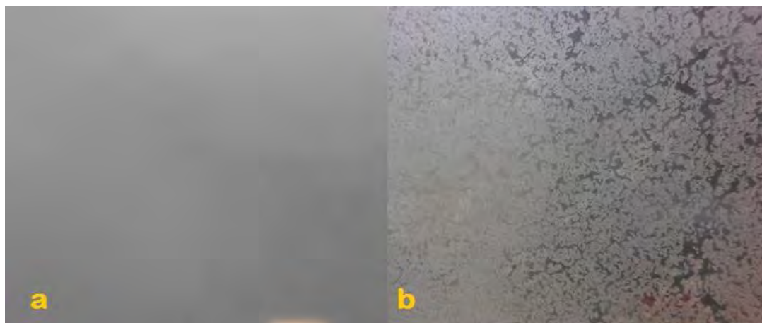
Figura 1. Fotos de las películas de a) almidón nativo 40 PLA 60 b) almidón modificado 40 PLA 60 utilizando un fondo negro.
