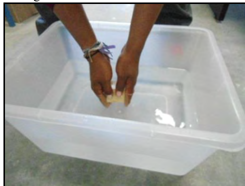
Figura 9. Fotografías del lavado con agua destilada de las 12 probetas
