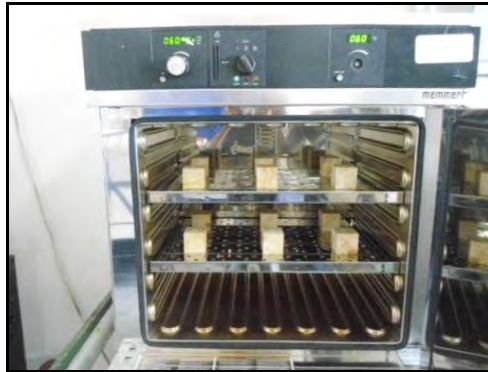
Figura 5. Fotografía del secado de las 12 probetas seleccionadas
