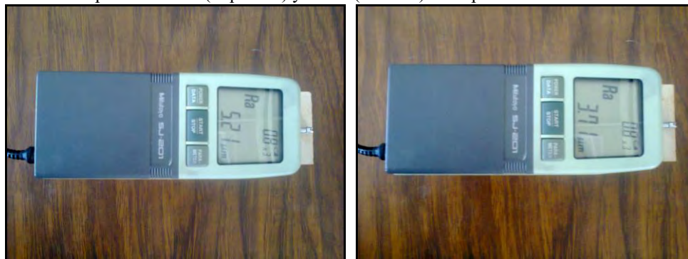
Figura 6. Fotografías de la medición de la rugosidad inicial de las probetas PC08 y PC12
