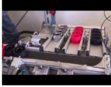
Figura 1b) Estación de trabajo SORTING, clasificando.
