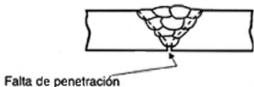
Figura 7 Falta de penetración en la raíz
