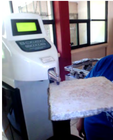
Figura 1. Prueba de dureza a ECOPLAF con el Durómetro.
