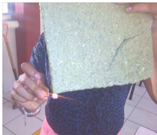
Figura 2. Prueba de combustión de ECOPLAF
