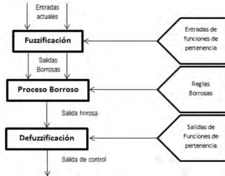
Figura 4. Operación del controlador borroso con estructura Mamdani.
