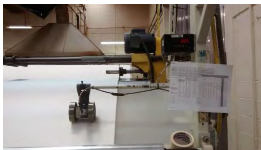
Figura 1. Medición de longitud lineal en un proceso utilizando un encoder.
