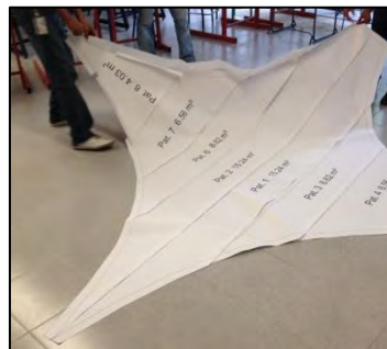
Figura. 12, 13, 14. El ejercicio sirvió para generar nuevas formas de diseño y manufactura de las velarías, también ayudo formar velarías singulares e irregulares, que dan un aspecto técnico y estético al proyecto de investigación.
