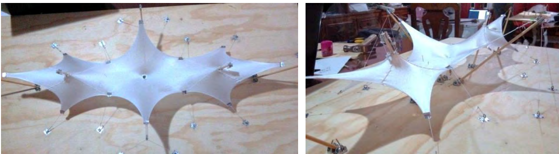
Figura. 6, 7. La experimentación de diseño estructural en la velarías y su funcionamiento en las conexiones constructivas ayudan a entender el comportamiento de la tensiones en la superficies de la tensoestructuras. Fuente: Morales (2013).
