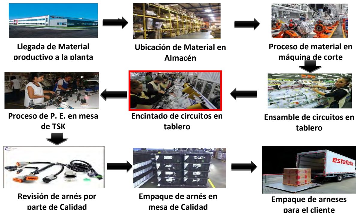
Figura 3.- Proceso general de fabricación de un arnés
