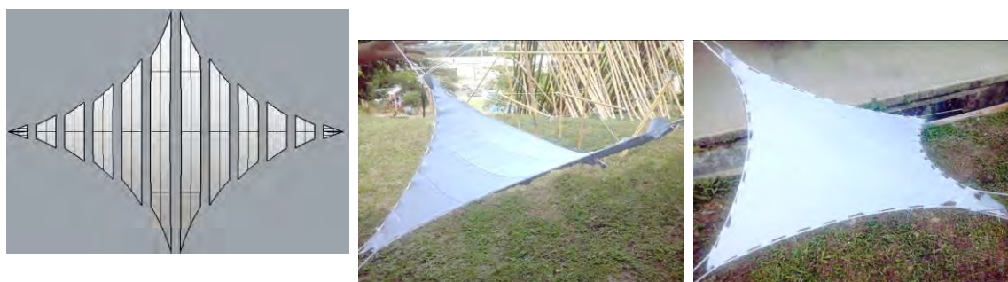
Figura. 8, 9, 10. El desarrollo del patronaje en esta investigación fue el punto de partida para desarrollar el prototipo final, ya que la construcción de estas superficies de doble curvatura es indispensable para unir la membrana. Fuente: Morales (2013).
