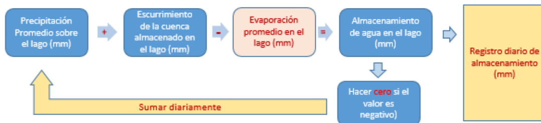
Figura 2. Procedimiento para estimar el almacenamiento del lago expresado en lámina (mm)
