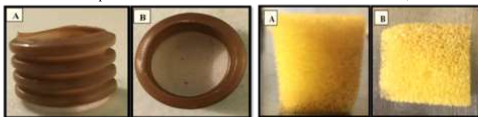
Fig. 1. Materiales de soporte empleados para la inmovilización microbiana. Dónde: (A) representa la parte lateral y (B) la parte frontal
