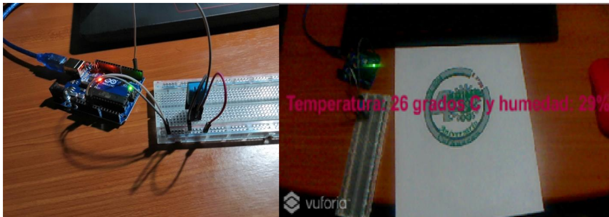
Figura 5. Sistema de adquisición de datos conectado al equipo de cómputo y programa ejecutable en funcionamiento.
