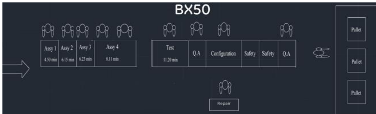
Ilustración 1: Diseño final de la línea de producción de BX50. (Línea híbrida de B450 & B650)
