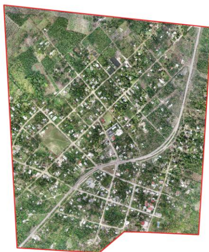
Figura 1. Polígono de interés (indicado en línea color rojo) para la generación de productos cartográficos correspondientes a la localidad rural de Sac-Xan. La imagen contenida es la ortoimagen resultante de los trabajos de producción cartográfica empleando vehículos aéreos no tripulados de bajo costo. El tamaño de píxel de la imagen es de 3.5 cm.
