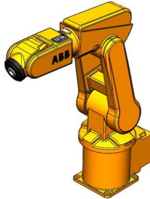
Fig. 3 Manipulador de 5 grados de libertad
