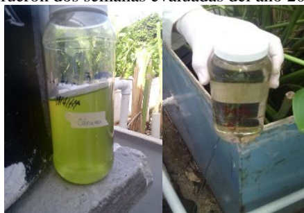
Figura 2. Toma de muestras de agua, izquierda agua de entrada, derecha agua de salida.
