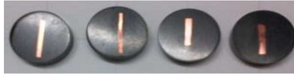
Figura 1. Probetas preparadas para la micrografía a las diferentes temperaturas de envejecimiento térmico
