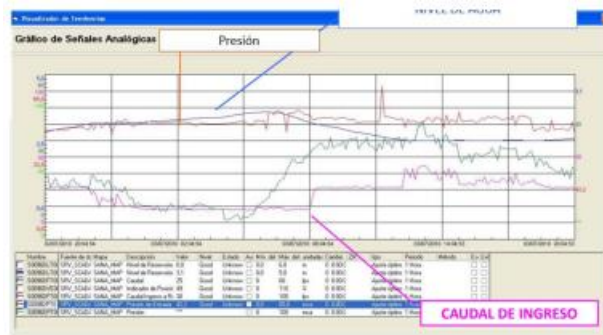
Figura 8. Gráficas del SCADA realizado con datos obtenidos del data logger.
