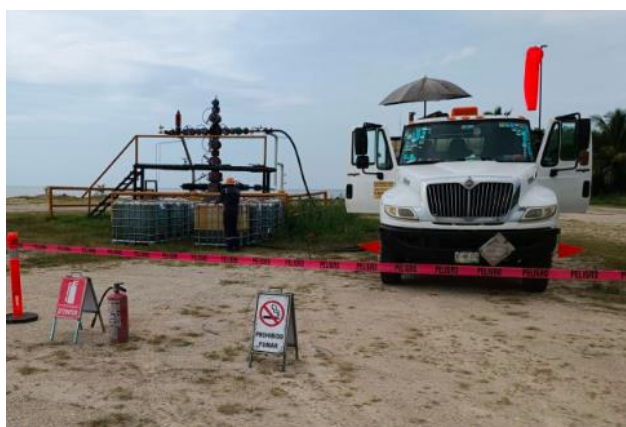
Figura 1. Unidad de alta presión conectado a la TP2 del pozo Tizon 201.
