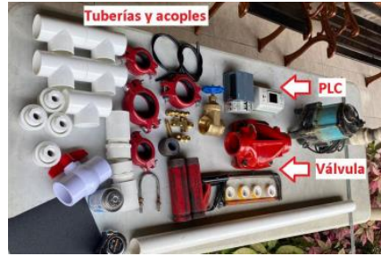
Figura 5. Componentes utilizados para el armado del prototipo.
