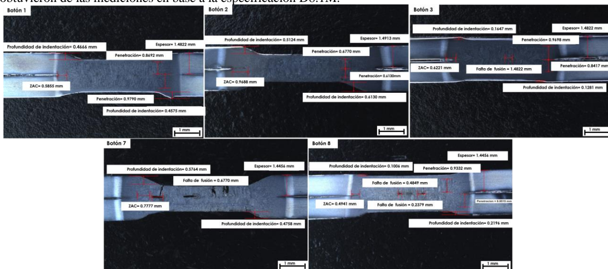
Figura 2. Macrográficas de los botones de soldadura.
