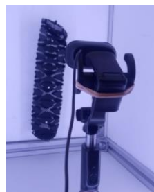
a) Calibración b) Identificación de puntos de movilidad Figura 4. Aplicación de un Sistema de Visión Artificial en estructuras flexibles
