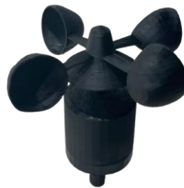
Figura 5. Sensor de viento impreso en 3D.
