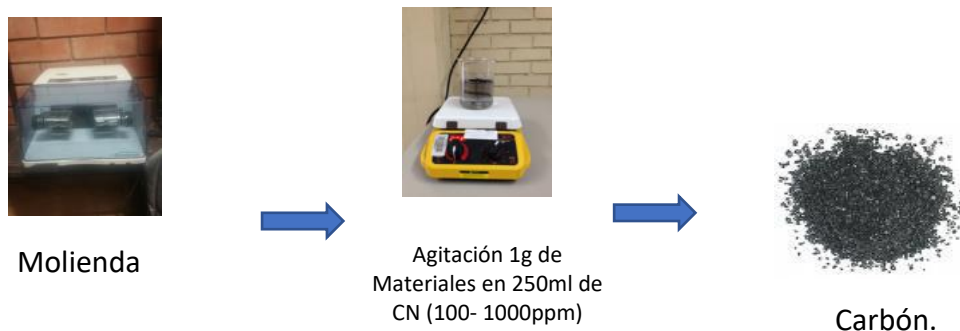
Figura 2.- Procedimiento de Cianuración con distintos materiales
