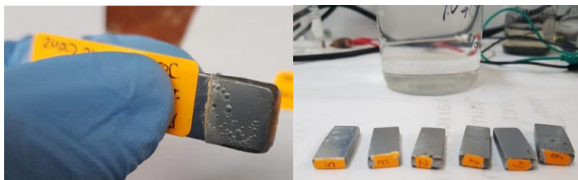
Figura 3. Probetas recubiertas con el polímero reforzado
