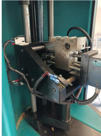
Figura 8. Ubicación de los sensores de límite de los ejes en la máquina Boxford CNC DUET.
