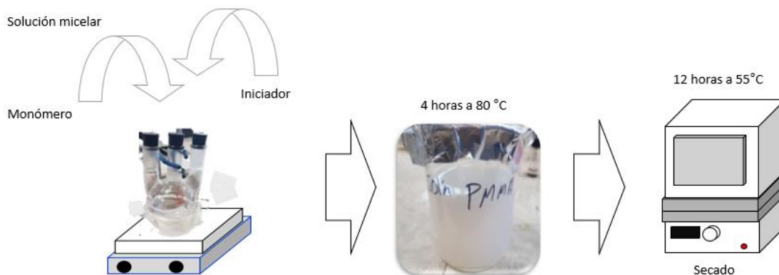
Figura 1. Síntesis del polimetilmetacrilato
