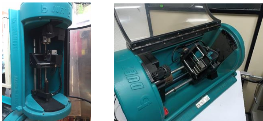
Figura 2.- Máquina Boxford CNC DUET.
