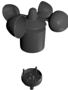
Figura 2. Diseño 3D de sensor de velocidad de viento (anemómetro).
