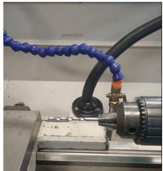
Figura.22 Perforacion con broca.
