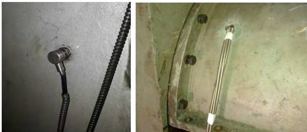
Figura 6. Montaje de sensor y extracción de cable de sensor del housing.
