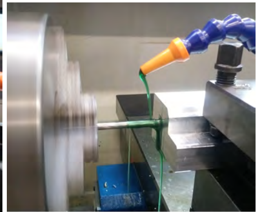
Figura.11 Perforacion con Broca
