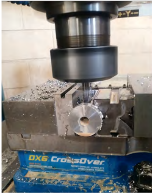
Figura.23 Perforacion de ranura.
