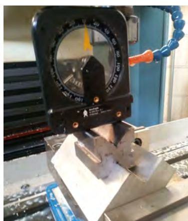
Figura.7 Nivelacion de pieza
