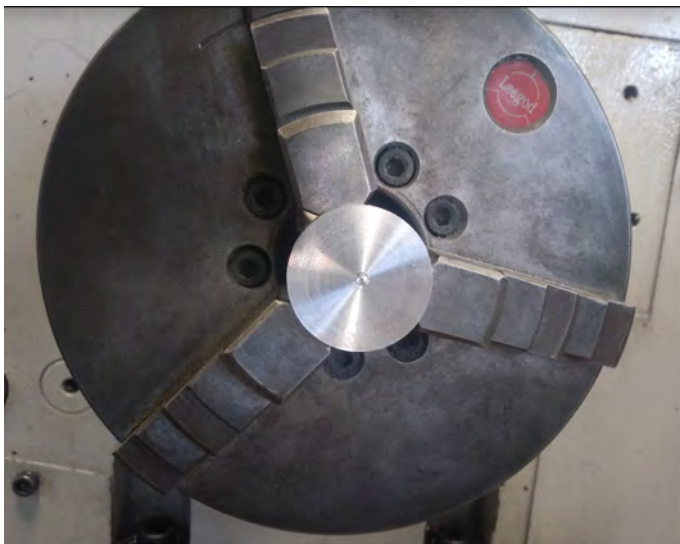
Figura.21 Colocar cilindro en el torno
