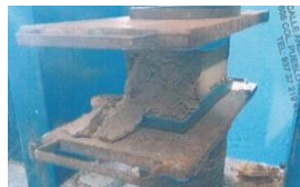
Figura 2 Ensayo de resistencia a la compresión en ladrillos
