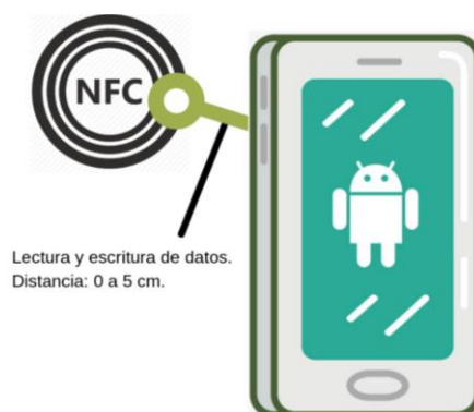
Figura 1. Interacción de dispositivo móvil y etiqueta NFC.
