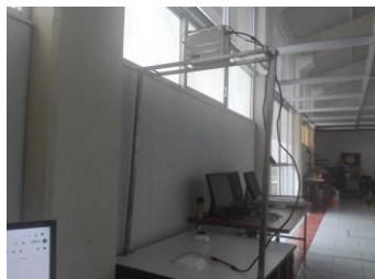
Figura 6 Experimento de proyección de Franjas
