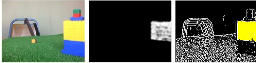
Figura 6. Detección de objeto amarillo. Imagen Original (izquierda) imagen de probabilidad (central), imagen binaria cromática (derecha).
