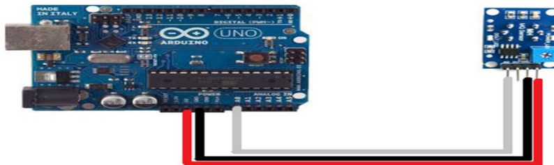
Figura 5. Conexión de cable dupont con módulo MQ2
