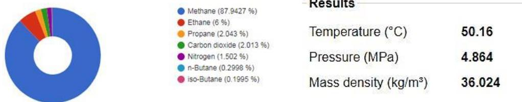
Figura 1. Composición de gas natural sintético y resultado de una cálculo de densidad.
