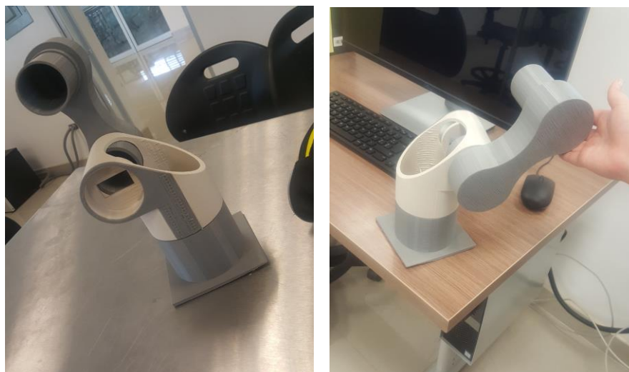
Figura 3 Dos vistas del armado de las piezas del prototipo elaboradas en impresora 3D.
