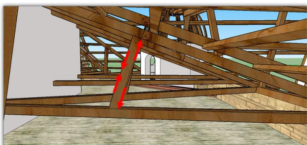
Figura 4 Diagonal comprimiéndose o tensándose.
