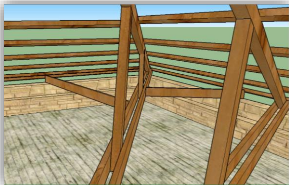
Figura.11 Arriostramientos presentes en la cercha.
