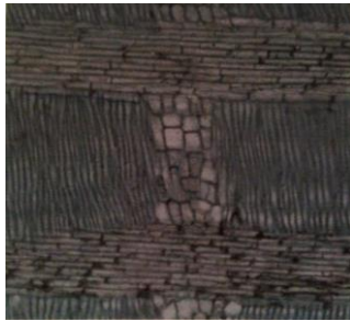
Fig.8 Corte R, a 100X. Radios de Composición homogénea.
