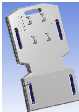
Figura 12. Colocación de soportes fijos en las caras
