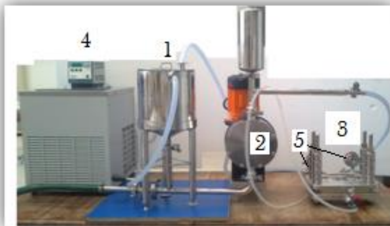
Figura 1. Sistema de ultrafiltración tangencial. 1-Tanque de alimentación, 2-bomba de desplazamiento positivo, 3-Módulo de filtración, 4-Sistema controlador de temperatura, 5-Manómetros entrada y salida de módulo de filtración
