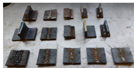
Figura 2: Uniones soldadas establecidas para el análisis.
