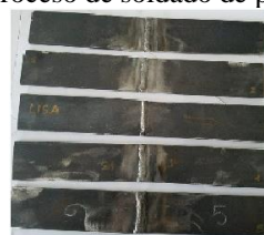
Figura 6: Probetas con diferentes biselados soldadas
