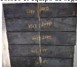
Figura 5: Biselados en las cinco probetas
