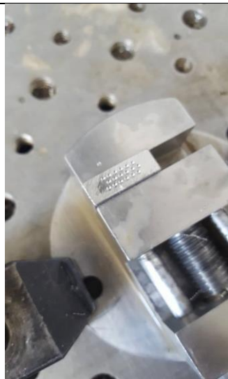
Figura 5. Barrenos con broca de centros.
