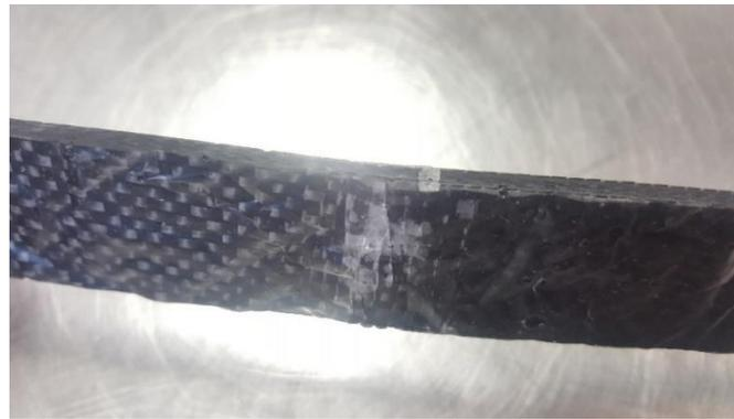
Figura 6 Fractura en probeta.
