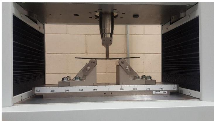
Figura 3 Probeta colocada para ensayo de flexión.
