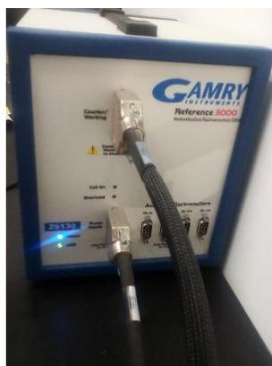
Figura 1. Potenciostato marca “Gamry instruments” modelo “reference 3000”.
