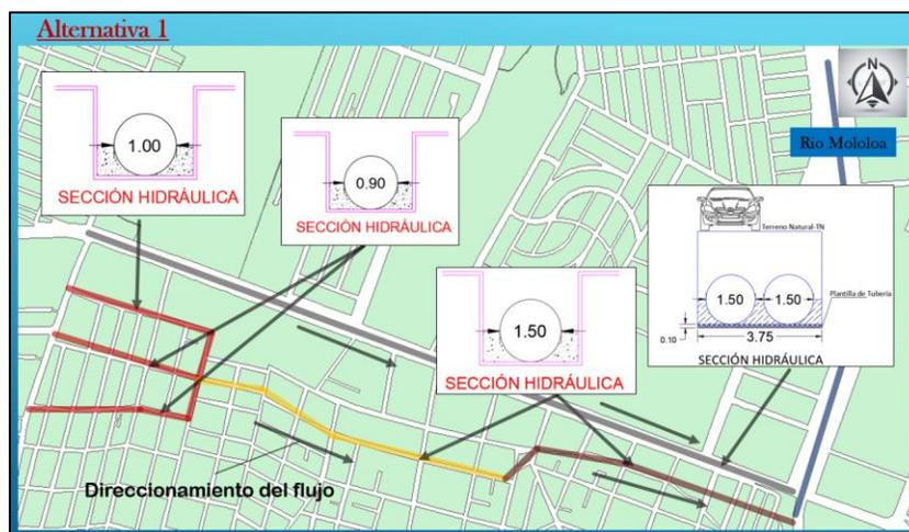
Figura 6. Resumen de red de distribución en planta y secciones hidráulicas de alternativa 1.
