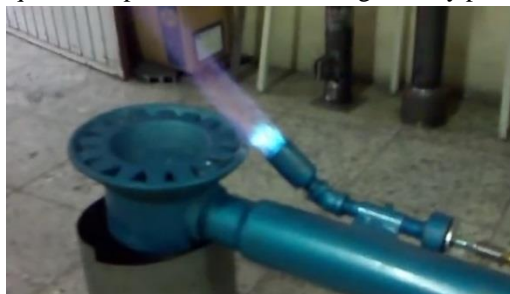
Figura 6.- Incorporación de un soplete para mantener viva la flama.
