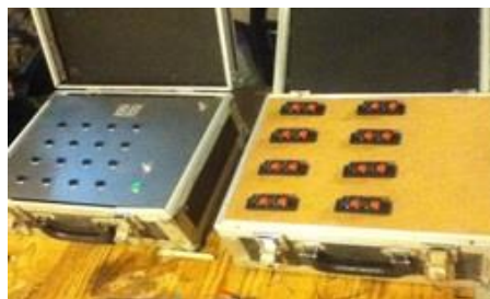
Figura 7. Consola de disparo, lado izquierdo caja de control, lado derecho la caja de potencia.
