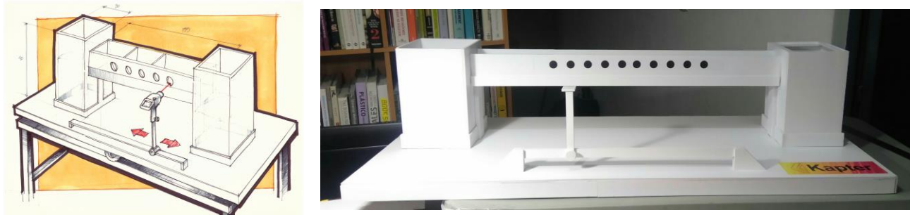
Figura 4. (Izquierda) Detalle de la propuesta de diseño de mesa única que incluye la colocación de los sistemas de láser (VLD) y de medición por termografía. (Derecha) Maqueta volumétrica, escala 2:1 del sistema de canal experimental. Se continúa con la idea de dos torres de base cuadrangular transparentes, canal con placa caliente de fondo y la posible colocación de al menos cinco mirillas de medición infrarrojas.
