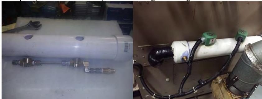
Figura 7. Colector múltiple implementado
