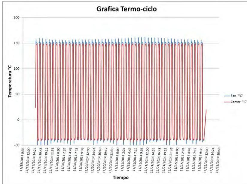
Figura 1. Grafica de perfil térmico (prueba termo-ciclo)
