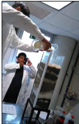
Figura 5. Filtración de agua de una laguna de agua dulce.
