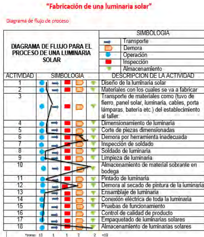
Fig. 2. Diagrama de flujo del proceso, donde se detallan los pasos que se siguieron para la fabricación de la luminaria.
