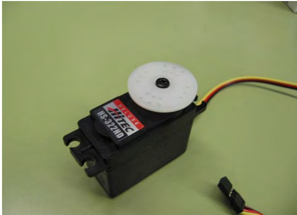
Fig. 3, Ejemplo del Servomotor y cables de conexión, utilizando en la fabricación de la luminaria con luminaria tecnología LED.
