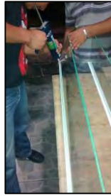
Figura 4. Armado del contenedor para los materiales filtrantes,
