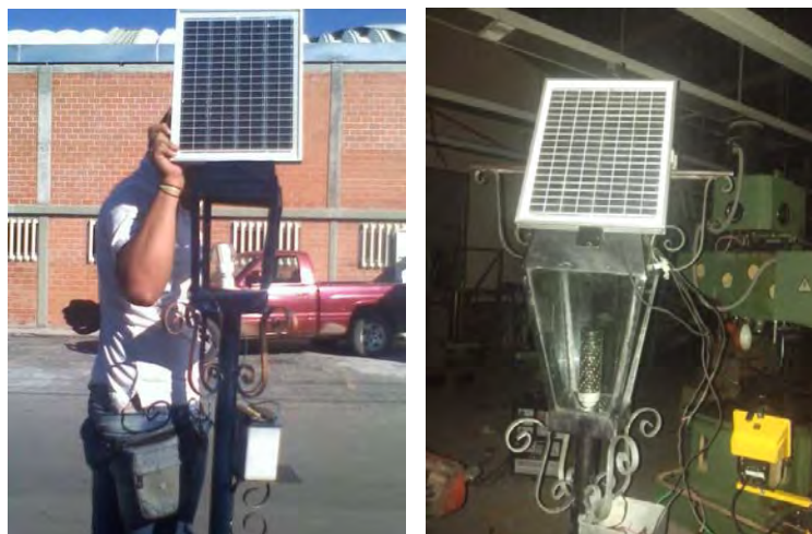
Fig. 5. Muestra de Luminaria con tecnología LED y panel solar terminado, obteniendo que su eficiencia lumínica es de mayor intensidad y calidad que una bombilla tradicional.
