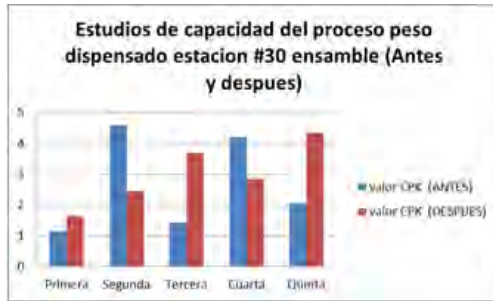
Fig. 5. Gráfico comparativo en los valores de CPK del proceso de ensamble línea #30.
