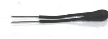
Figura 1. Termistor sin Preformar
