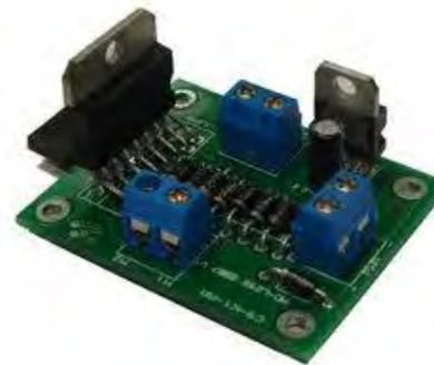
Figura 3. Tarjeta con l298 , puente H
