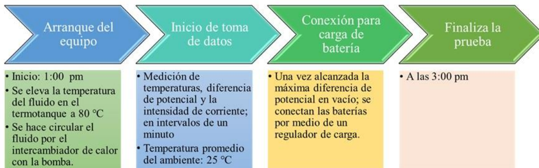
Figura 4. Esquema de secuencia para las pruebas experimentales con el banco de prueba.
