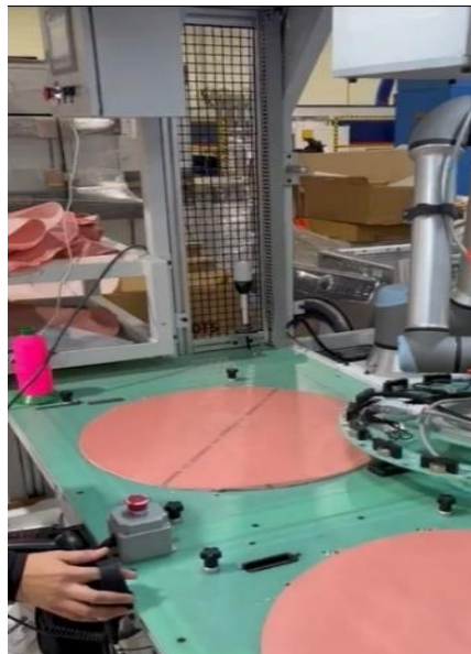
Figura 3. Prototipo robótico para costura e inspección de bolsas de aire.
