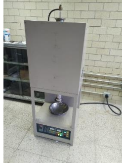
Figura 2. Horno tubular, el cual cuenta con una cámara que se llena de gas inerte (imagen obtenida por el alumno).
