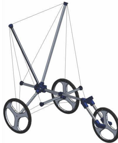
Figura 2. Concepto de chasis VTH propuesto
