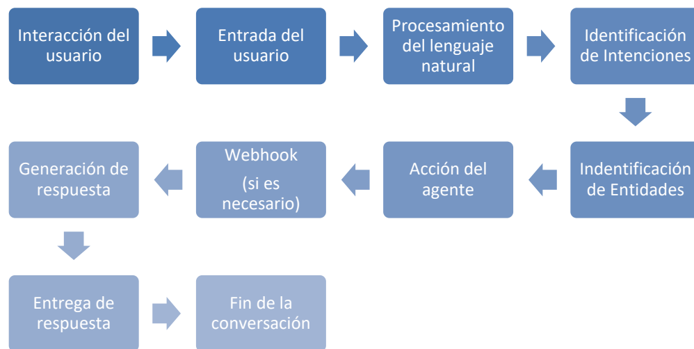
Figura 3. Funcionamiento básico de Dialogflow al interactuar con un usuario del ITTII
