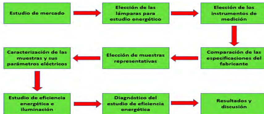
Figura 1. Diagrama a bloques del procedimiento metodológico del estudio de calidad y eficiencia energética en lámparas LED. [Fuente: Propia]
