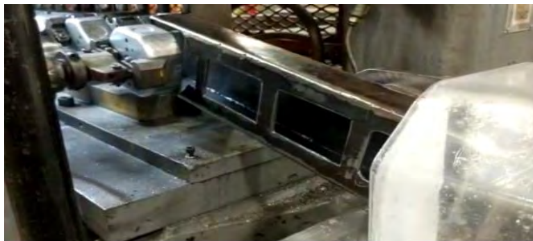
Figura 11. Posicionamiento automático de caja octogonal en resbaladilla.
