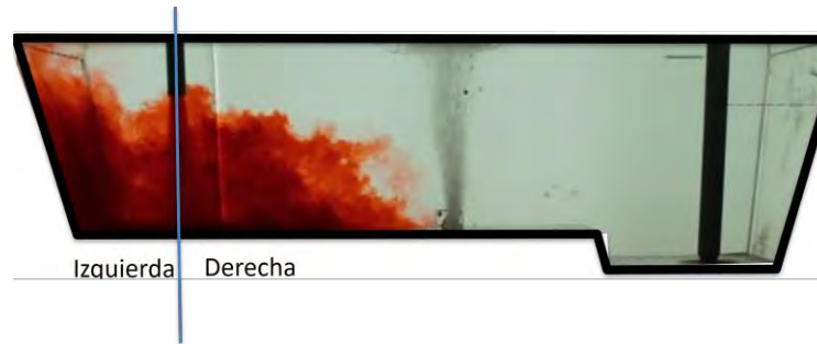
Figura 1 Distribuidor sin inhibidor con inyección de aire.
