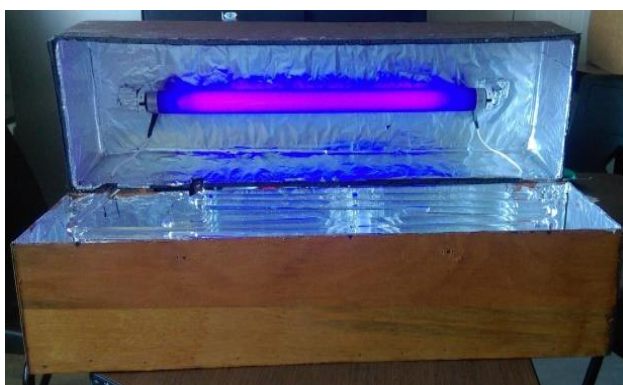
Figura 2. Diseño de dispositivo para degradación fotocatalítica.
