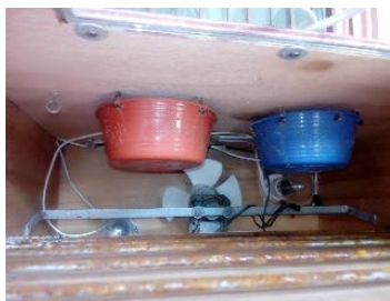
Figura 4. Fuentes de humedad
