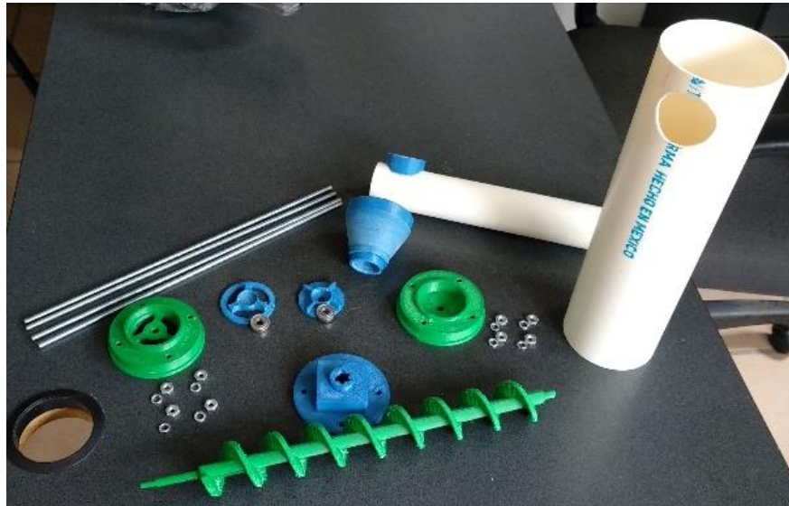
Figura 10. Piezas que componen el extrusor didáctico. Fuente: propia.
